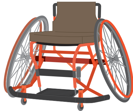
圖一、運動輪椅屬於依照身形訂製，因此總寬度通常大於無障礙廁所之入口（門寬至少 80 公分）。
