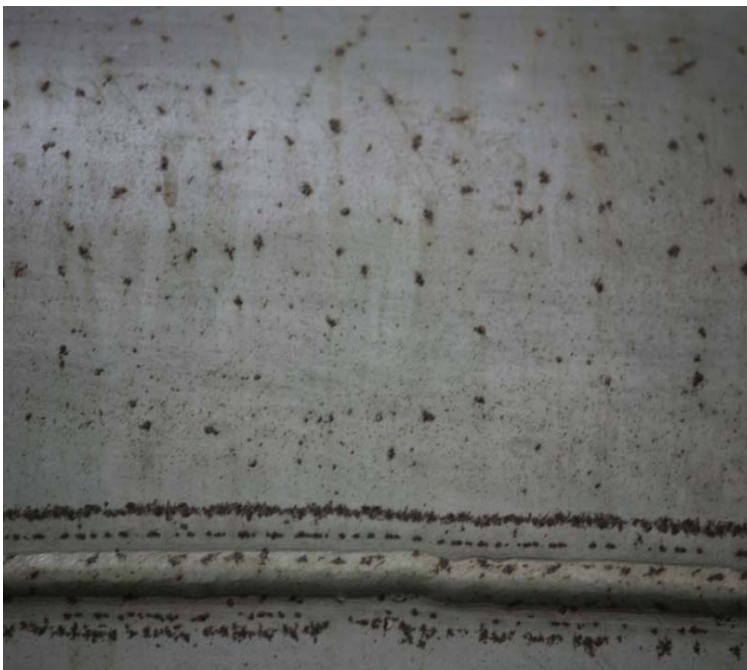
過濾桶如採用不銹鋼設計應確保其品質，以避免銹蝕（本案設置未滿 2 年）。 不銹鋼之等級最好為 SUS-316，至少應為 SUS-304
