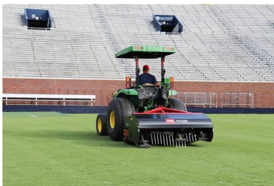
圖9 實心打孔機草皮打孔25公分深 (圖片提供 / 劉田修)
