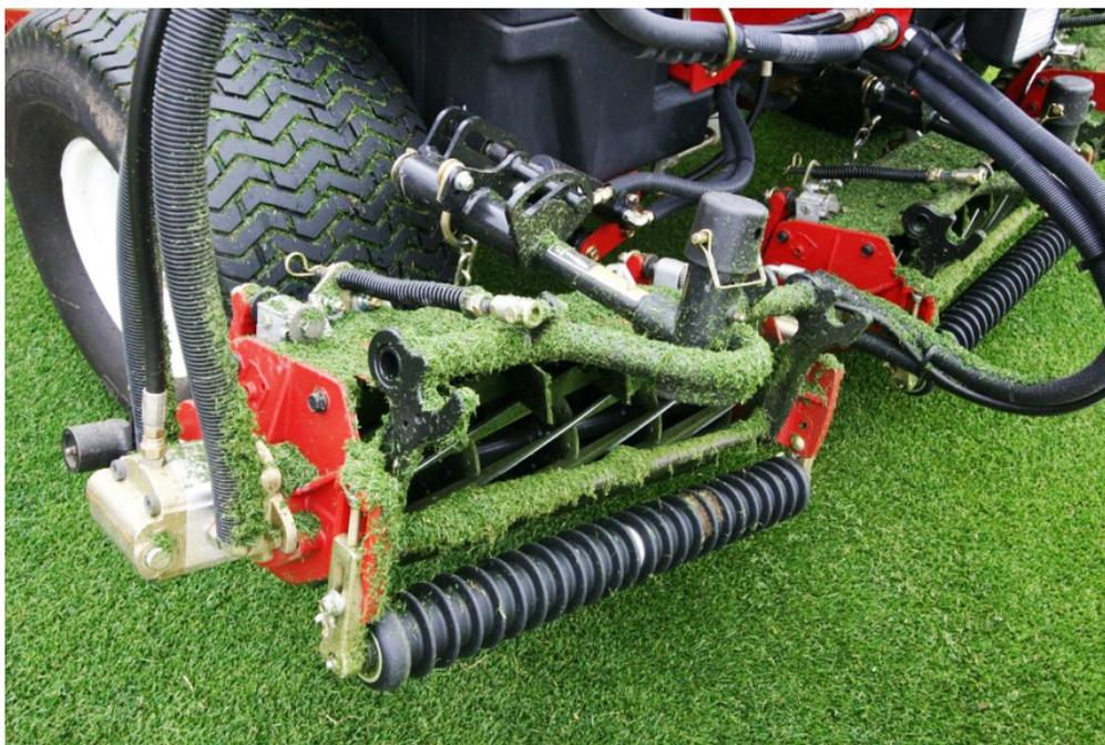
圖7 五組刀盤之滾刀剪草機（圖片提供 / 劉昆祐）
