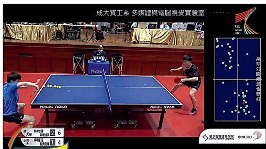
圖4 全大運桌球軌跡追蹤與即時落點分析展示 (Wu, Shieh, et al., 2022)
